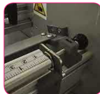
Pokrętło regulacyjne umożliwiające łatwe ustawienie położenia modułu z ostrzami Y na maszynie.
